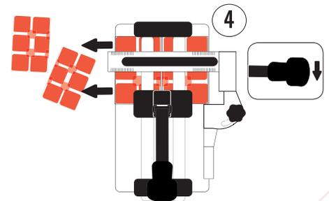
4-Una vez rayada la pieza, accione la palanca del separador hacia abajo y separe las piezas cortadas de azulejo
